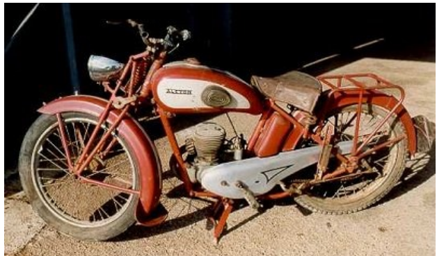
Alcyon type 25 standard met 125 cc Zurcher tweetakt blokje (1950).
