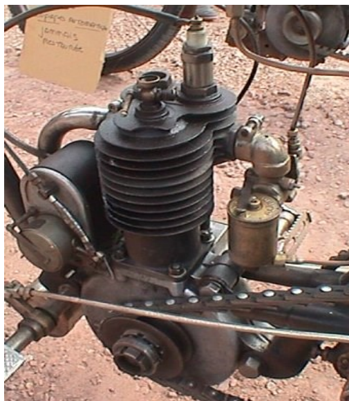
Alcyon 250 cc 1914 met 2,5 CV Zurcher motor, riem aandrijving, Alcyon carburateur Claudel licentie.
